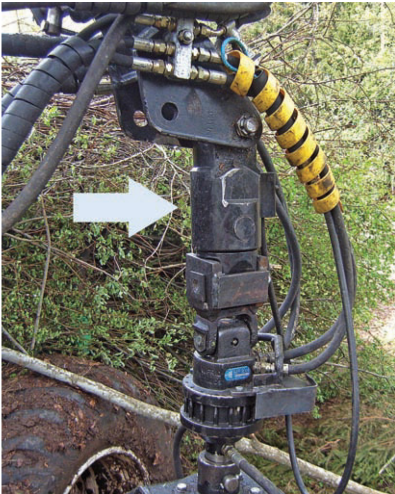
Kuva 2. Kuormainvaaka asennettuna kuormatraktoriin puomin ja kouran väliin. (Kuva: Risto Lauhanen)
