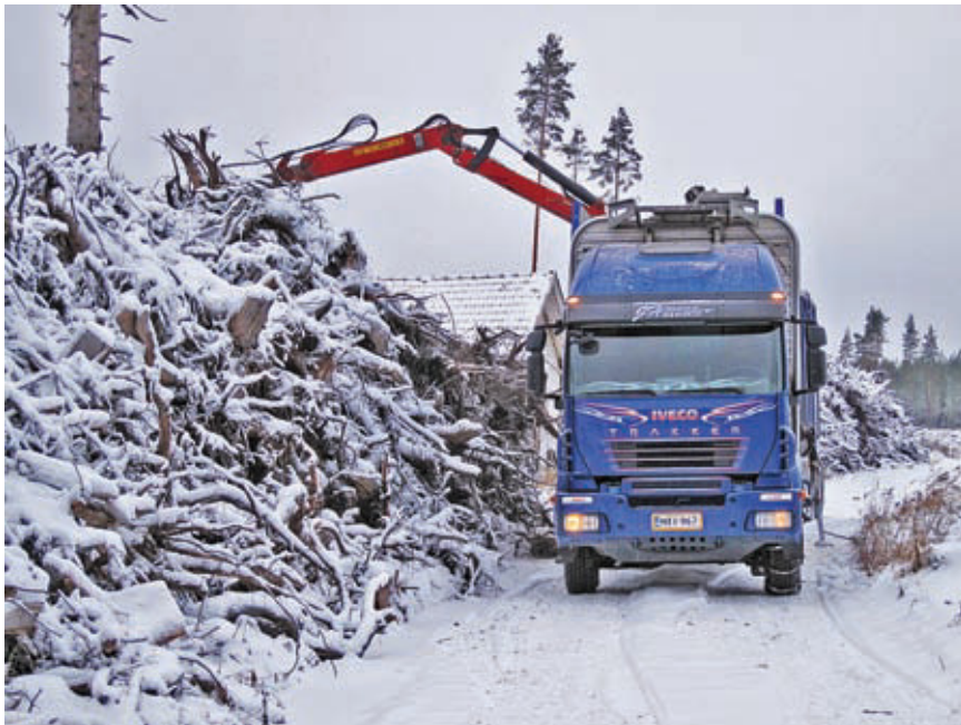
Kannot voidaan kuljettaa paloina tienvarsivarastosta käyttöpaikalle, jossa ne murskataan ennen polttoa. (Kuva: Jussi Laurila)
