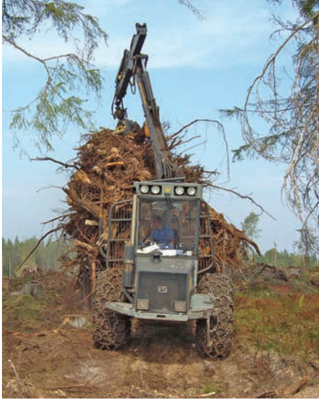
Kantojen metsäkuljetus voidaan tehdä tavallisella kuormaakantavalla metsätraktorilla. (Kuva: Jussi Laurila)
