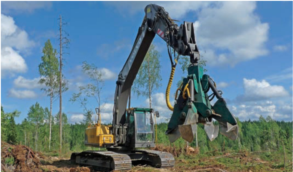
Männynkantojen nostaminen on vielä vähäistä, mutta lisääntynee jatkossa, koska niissä on huomattava energiapuuvarasto. Puolukkatyyppiä karummilta mailta männynkantoja ei ole syytä nostaa, jotta maan ravinteet eivät vähene. Kuvassa on nostolaite, jolla saadaan paalujuuri katkaistuksi sekä kivet ja maaines ravisteltua tehokkaasti irti kannoista ja juurista. (Kuva: Tapani Tasanen)
