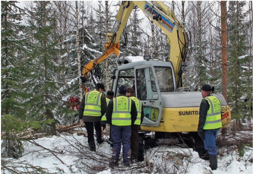
Tuomarniemen konenäytöksessä maaliskuussa 2010 herättivät yli tuhatpäisen yleisön mielenkiintoa mm. kaivinkonealustalle rakennetut energiapuuharvesterit. (Kuva: Tapani Tasanen)
