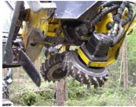
Vasemmassa kuvassa puun katkaisu tapahtuu giljotiiniterällä. Oikean puoleisessa kuvassa on koura ketjusahalla ja rullasyöttölaitteella. (Kuvat:Tiina Sauvula-Seppälä)
