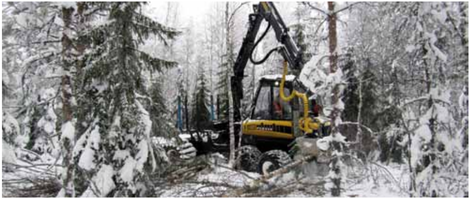
Joukkokäsittelykouralla ja kuormainvaa'alla varustettu ajokone suorittaa energiapuun hakkuun ja lähikuljetuksen. ( Kuva: Veli-Pekka Kauppinen)
