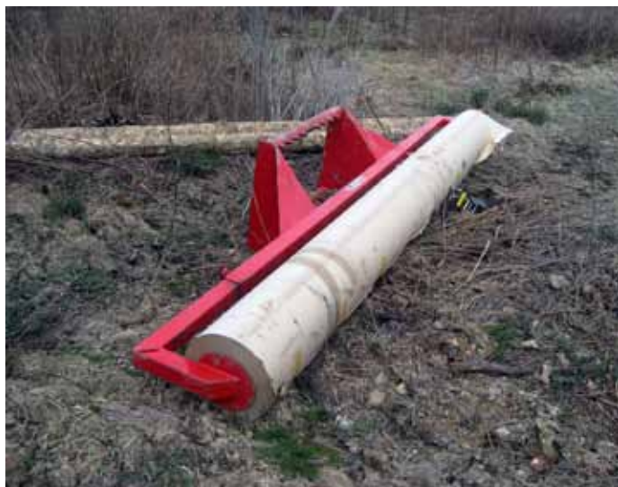
Peitepaperin saa levitettyä hyvin kasan päälle, kun se on kiinnitetty peiterautaan, josta kourakuormaimella saa hyvän otteen. (Kuva: Veli-Pekka Kauppinen)
