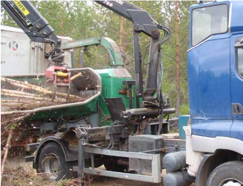
Kuvissa rumpuhakkuri, hakkurin toimintaperiaate ja haketta (vasen seulottu 50 mm seulalla, oikea seulomaton). (Kuva: Urpo Hassinen, kuva hakkeesta: Tanja Lepistö. Piirroksen lähde Knuuttila, 2003)
