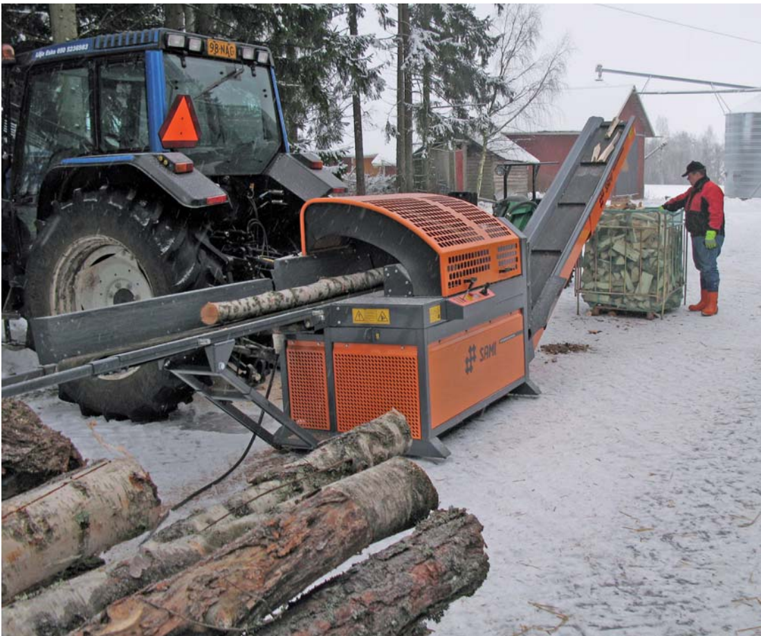
Nykyään on markkinoilla hyvinkin automatisoituja pilkekoneita. Kuva: Marko Ämmälä.
