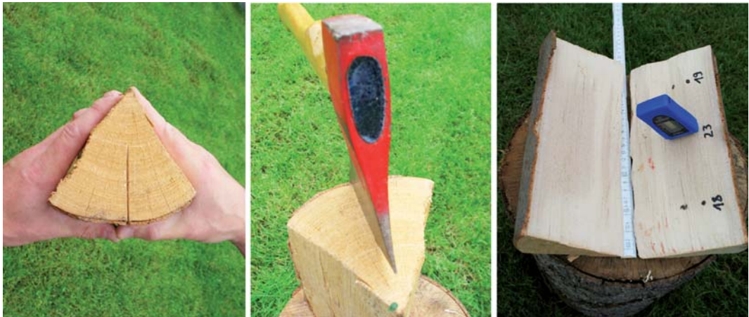
Esimerkki kuivan pilkkeen kosteuden mittaamisesta. Kuva: G. Krämer.
