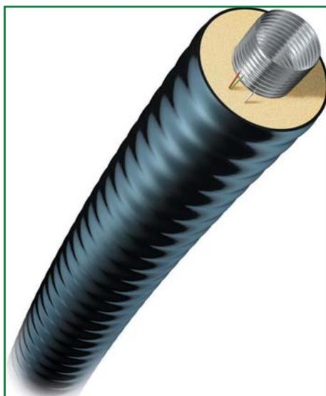
Suosittelavaa on, että taipuisten, kiepeillä olevien putkistojen eriste on kiinnivaahdotettua polyuretaania, jolla on erinomaiset lämmöneristysominaisuudet. Polyuretaanieristeisissä, taipuisissa putkissa, ei myöskään esiinny lämpölaajenemisiongelmiä, vaan virtausputkien lämpöliike kuoleentuu kiinnivaahdotettuun rakenteeseen. Lämpöhäviöt putkistoissa vaihtelevat 15 - 30 W/m (tarkistettava valmistajilta), riippuen mm. putkimateriaalista
