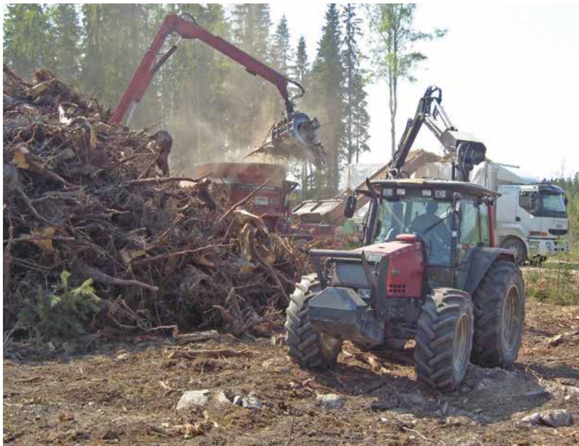
Kuva 17. Kantojen murskaus on vaarallista työtä. Murskauksen yhteydessä pölyä ja melu on kova. Lisäksi kiviä ja puunkappaleita voi lennellä lähimaastoon. Kuva Risto Lauhanen.
