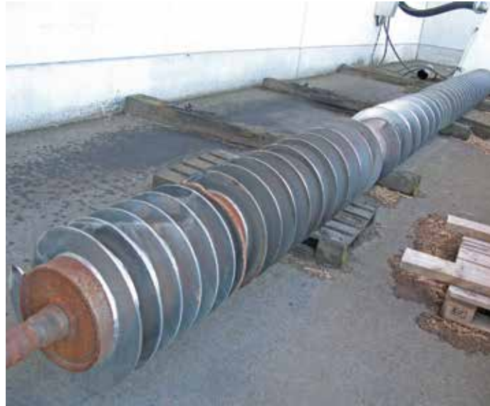
Kuva 20. Kantomurske epäpuhtauksineen kuluttavat kuljetinlaitteistoa. Kuva: Juha Viirimäki.
