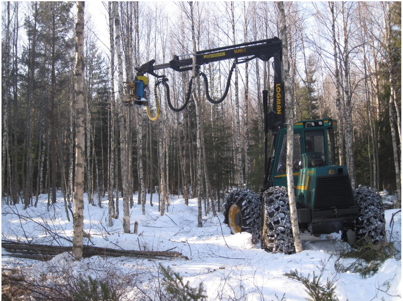
Pieni ensiharvennusharvesteri energiapuukohteella. (Kuva: Ismo Makkonen)
