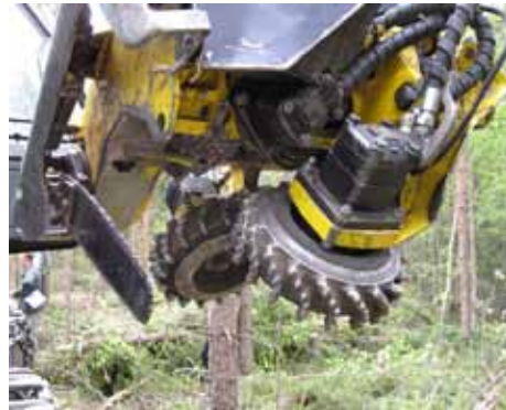
Vasemmassa kuvassa puun katkaisu tapahtuu giljotiiniterällä. Oikean puoleisessa kuvassa on koura ketjusahalla ja rullasyöttölaitteella. (Kuvat:Tiina Sauvula-Seppälä)
