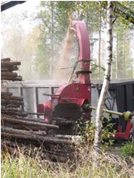
Laikkahakkuri, hakkurin toimintaperiaate ja haketta (Kuvat: Tanja Lepistö. Piirroksen lähde Knuutila, 2003)
