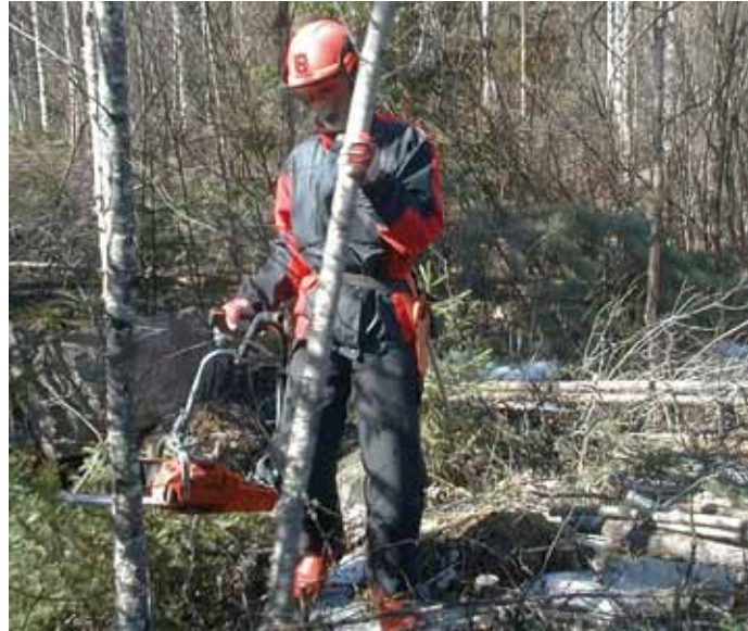
Siirtelykaadossa metsuri siirtää korjatut puut vapaalla kädellä suoraan kourakasoihin. (Kuva: Hannu Humalamäki)
